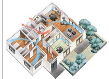
計画された換気経路にもとづいて、ゆるやかな空気が流れ、室内空気のよどみを解消。空気のよどみによる室内的温湿度上昇を抑制し、不快な結露の発生を抑えます。インシャルコストを抑えたベーシックな排気型の計画換気システム
