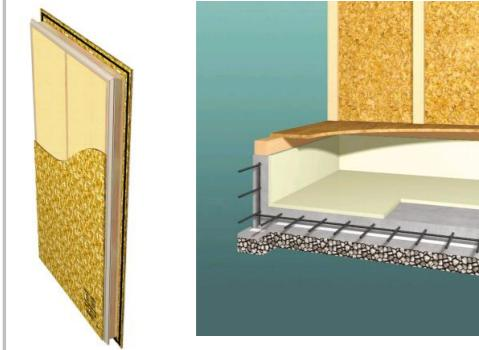
冷暖房効率が高く、防音、結露効果も大きいパネルを在来軸組みの外壁すべてに配置する。材料品質は地球にやさしい次世代省エネルギー基準に対応。
